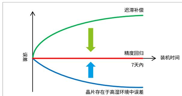
低露点温度应用时, 由于连续干燥晶片可能造成测量值如蓝色曲线造成使用初期精度未达产品标准。补偿藉由绿色曲线的补偿(迟滞补偿)缓解, 使安装初期也可达到产品精度标准。
