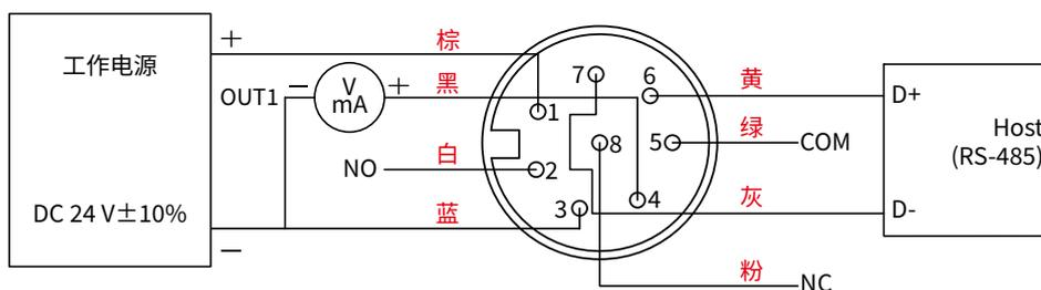
\*请确认产品与连接RS-485之仪器共地, 避免接地电压差造成损害。
